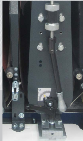
Sistema on-off manuale Manual on-off system Manual del sistema de encendido y apagado
