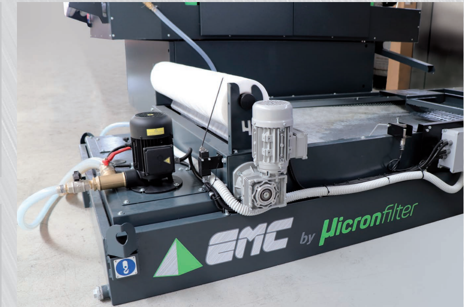
Vasca di raccolta fluidi Tank fluid recovery Récupération de fluide de réservoir
