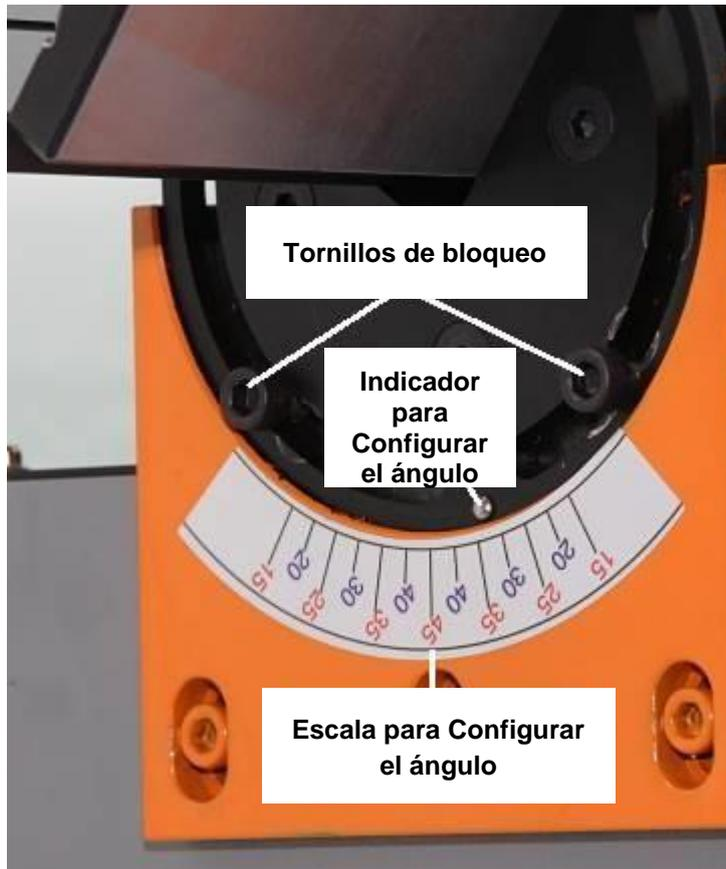
Afloje los tornillos de ambos lados. Incline el prisma hasta el ángulo deseado y apriete los tornillos de bloqueo.
