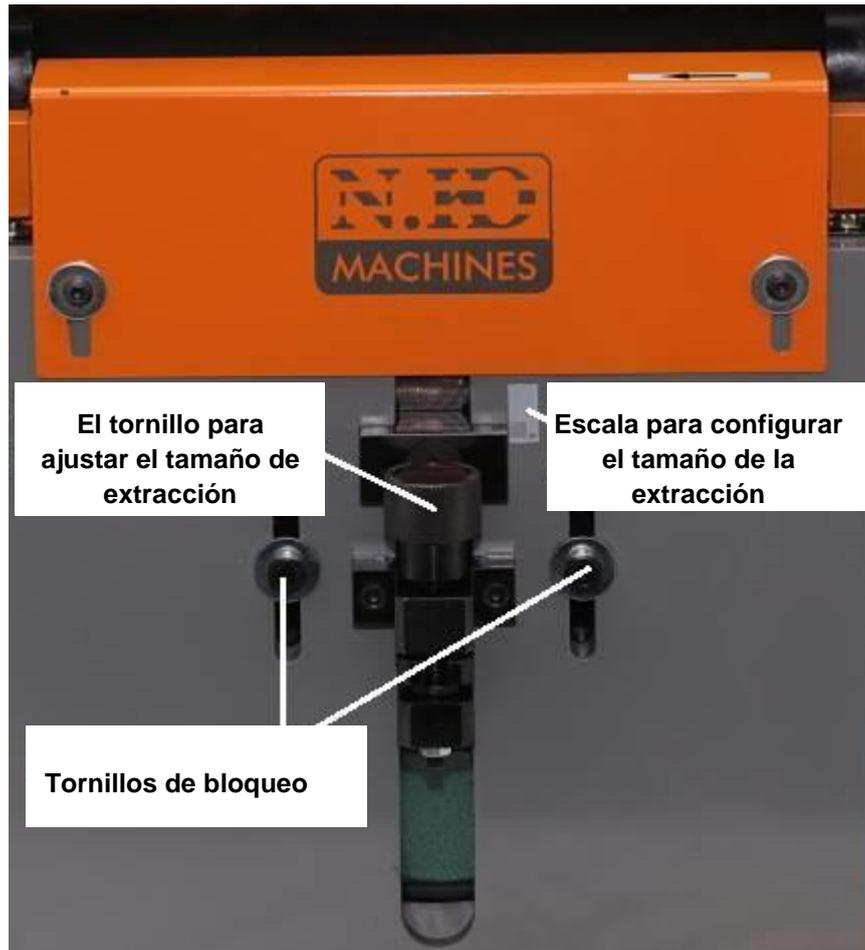
En caso de que necesite utilizar la máxima extracción posible del dispositivo, divida el biselado requerido en varios pasos.
