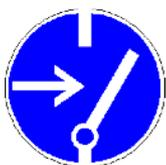
No se pueden alimentar componentes sujetos a mantenimiento y reparación. Estos componentes desconectados deben comprobarse mediante un dispositivo de medición bipolar para asegurarse de que no estén alimentados. A continuación, estos componentes deben conectarse a tierra y los componentes cercanos que reciben alimentación deben aislarse.
