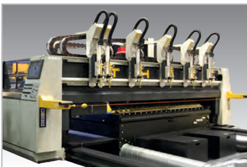
Rear area of the machine for multiple uses: oxy cutting, welding, blasting, etc. Zona posterior de máquina para usos múltiples: oxicorte, soldadura, granallado, etc.
