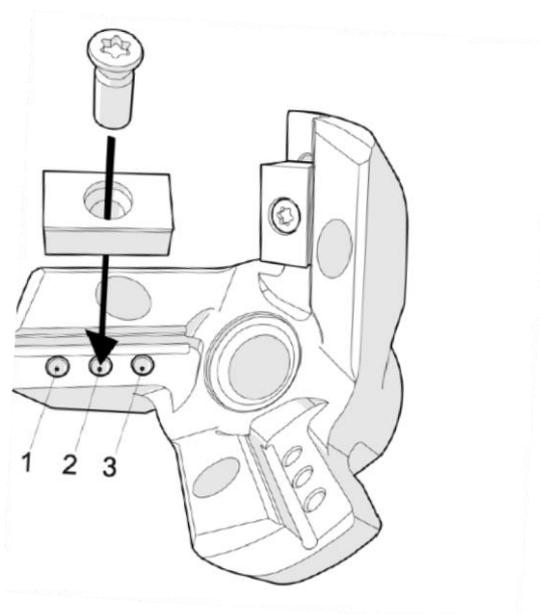
Ahora tiene que montar la herramienta preparada en el B15 Electra, B15 AIR o, alternativamente, en el B10 Electra. Atornille la herramienta Twister en el husillo de la máquina y apriétela sensiblemente con la llave de tubo suministrada.
