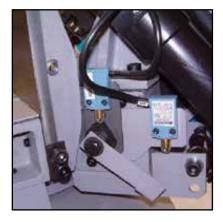
Sincronización de movimiento por rodillos RTP/RTD y cabeza (OpciorQP)TIONAL SIRIO 370 SH-E está dotada del sistema de sincronización entre el movimiento del cabezal de corte y el movimiento de la mesa de rodillso RTP o RTD (dependiendo de cual de las dos está en uso)
